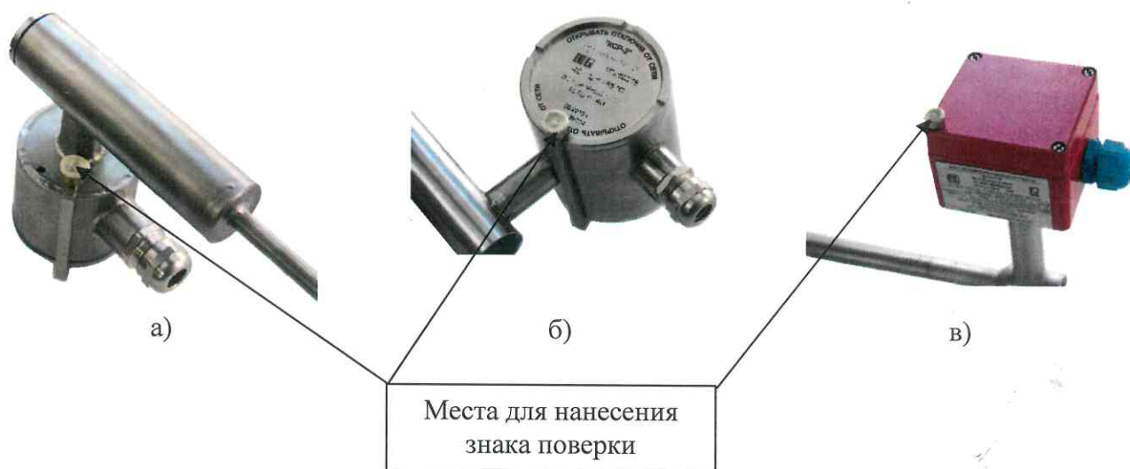
Рисунок 3 – Схема пломбировки от несанкционированного доступа, обозначение мест нанесения знака поверки
